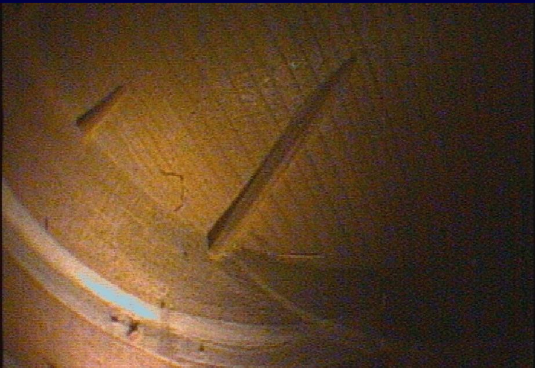
Laute 7: Radialrippen in Stegnähe
